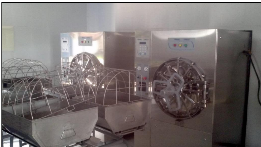
Figura 9.9. Autoclaves instaladas na Central de Resíduos Sólidos - Porto de Recife. Fonte: Manual de Boas Práticas – Porto do Recife (2014).
