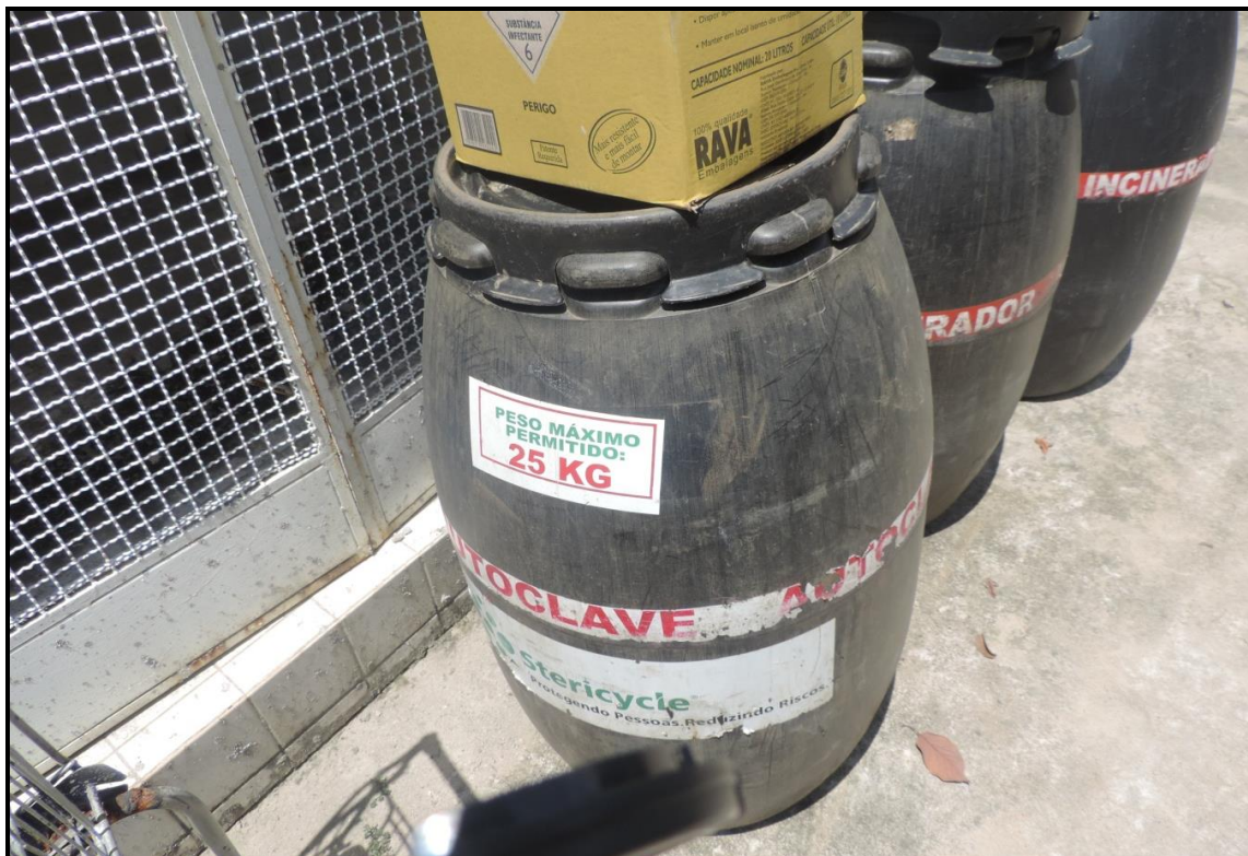
Figura 5.4. Recipientes de empresa terceirizada, no município de Itapissuma, com identificação de tratamento ao qual o resíduo é destinado e identificação do peso máximo, auxiliando na segregação e acondicionamento do RSS. Foto: CARUSO JR., 2014.
