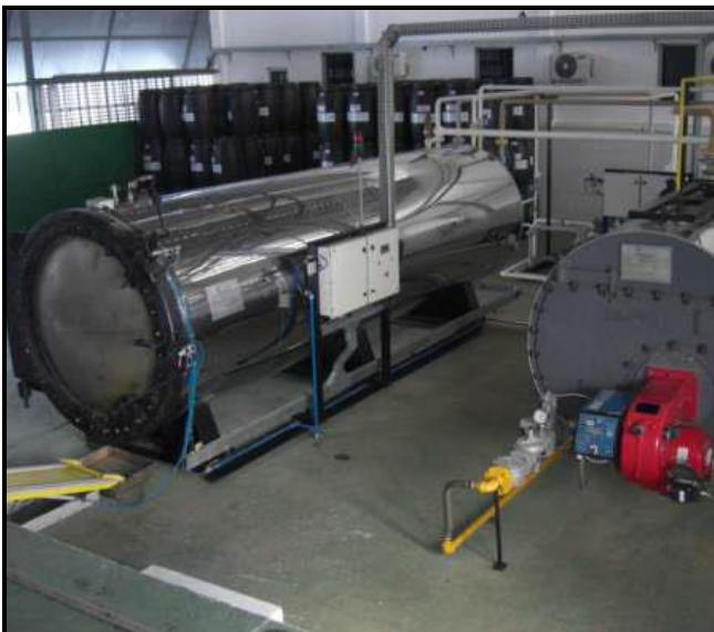
Figura 5.14. Autoclaves nas instalações internas da Brascon (à direita) e incinerador (à esquerda). Fonte: Portfólio Brascon, [2014].
